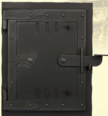
425 - Dvířka popelníková Burnet stavební rozměr š215 x v275 vnější rozměr š265 x v325 x hl55
