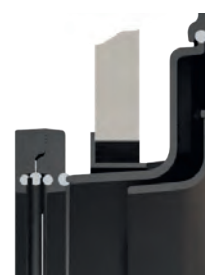
Tür „schwebend“ vor Ofenhülle mit Anbaurahmen
