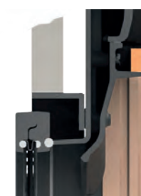
Tür abgesetzt zur Ofenhülle mit Anbaukante
